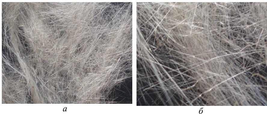
Рисунок 18 – Микрофотографии минеральных волокон( \times 300 ):
