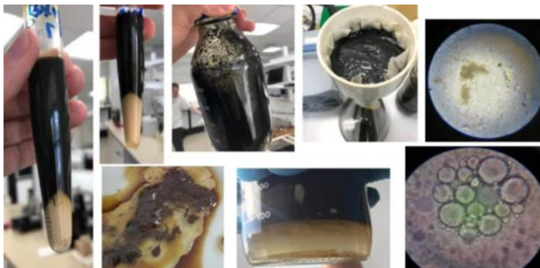
Рисунок 1–Примеры стойких ВНЭ и промежуточных слоев на объектах добычи нефти
