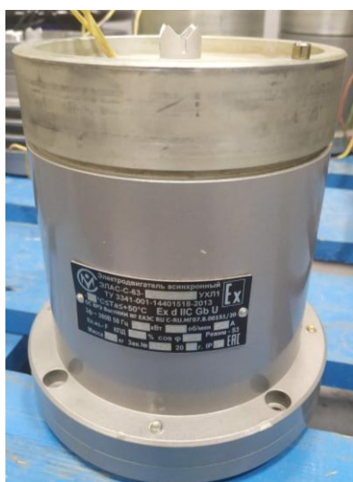
Рисунок 61. Внешний вид (а) и шильдик (б) электродвигателя ЭЛАС-С63-0.12-1500
