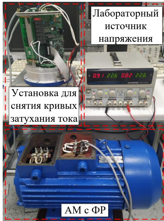
Рисунок 52. Внешний вид АМ с ФР МТН011-6У1, подключенной к лабораторной установке для получения кривых затухания тока фазных токов ротора
