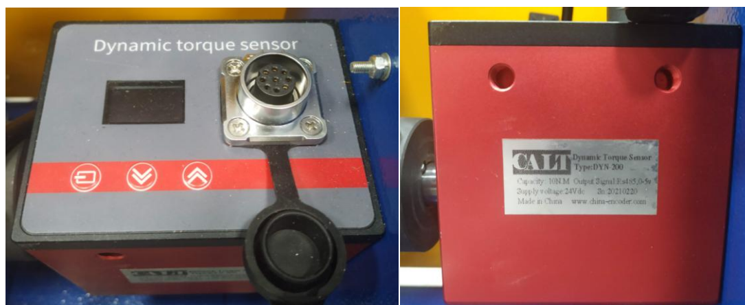
Рисунок 69. Внешний вид датчика момента DYN-200
