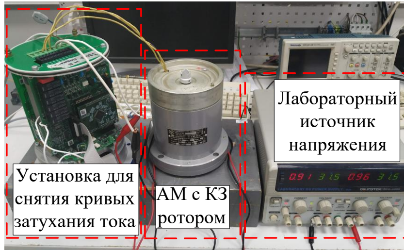
Рисунок 62. Внешний вид АМ с КЗ ротором ЭЛАС, подключенной к лабораторной установке для получения кривых затухания тока фазных токов статора
