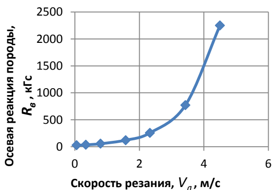
Рис. 11. Зависимость осевой реакции горной породы R_{в} от скорости резания v_{л} при постоянной величине срезаемого резцом слоя h=\text{const} [18]
