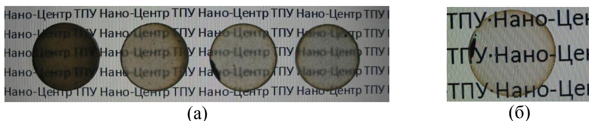
Рисунок 4.13 – Образцы керамики на основе \text{MgAl}_2\text{O}_4 (а) до механической полировки; (б) после механической полировки, изготовленные методом ЭИПС
