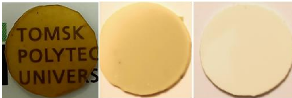
Рисунок 4.22 – Фотографии керамики на основе иттрий-алюминиевого граната, активированного церием YAG-керамики, изготовленные методом электроимпульсного плазменного спекания
