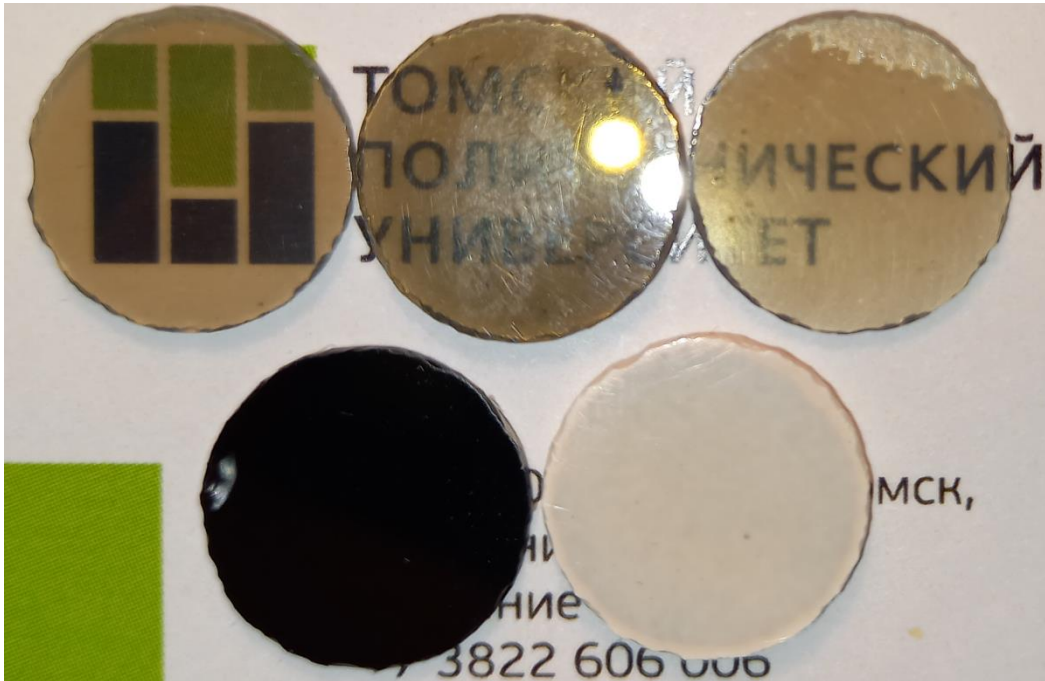
Рисунок 4.4 – Фотографии образцов диоксид циркониевой керамики стабилизированной 10 % Y_2O_3 , изготовленной методом ИПС, после механической обработки
