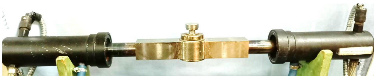
Рисунок 2.8 – ультразвуковая пресс-форма с радиальным подведением УЗ-колебаний, используемая в работе
