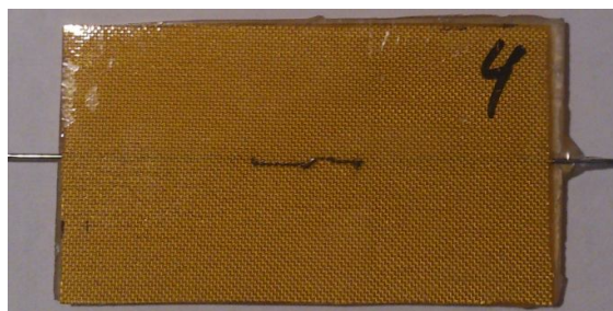
Рис. 2. Развитие разряда в композиции ПММА–Имидофлекс 292
