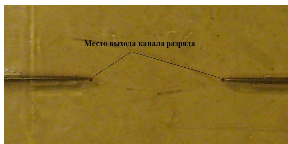
Рис. 1. Развитие разряда в композиции ПММА – полиимидная пленка
