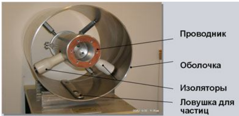
Рис. 2. Устройство газовой линии
