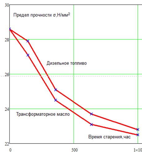
Рис. 4. Предел прочности оболочки отечественного провода при разрыве, Н/мм 2
