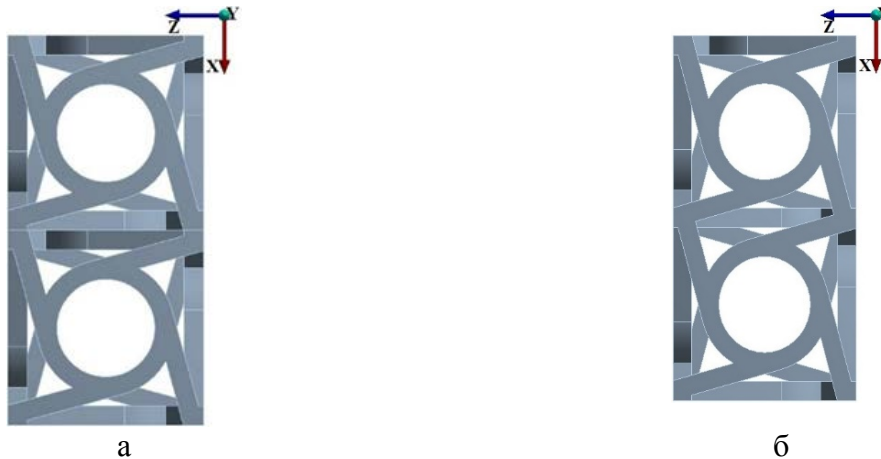
Рисунок 1 – Соединение элементарных ячеек методом (а) присоединение, (б) внахлест
