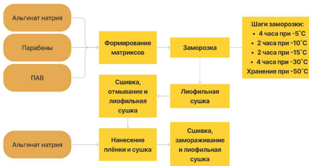
Рисунок 1 – Схема изготовления двухслойных тканевых эквивалентов на основе альгината натрия с включением парабенов
