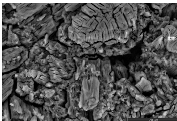
Рисунок 3 - СЭМ-изображение структуры пористого кремниевого покрытия, нанесенного на подложку из никелида титана x3000
