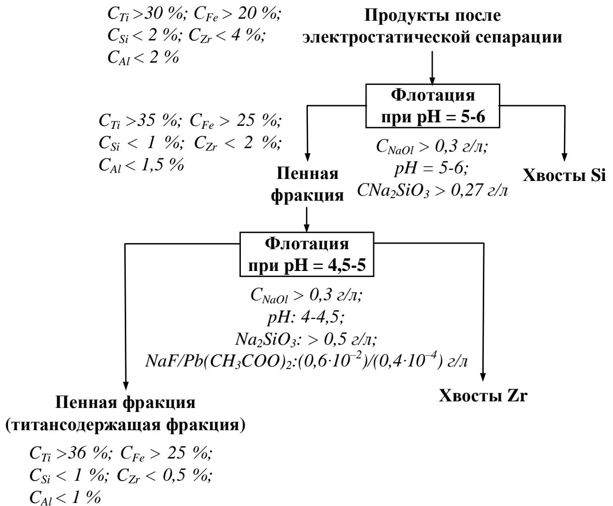
Рисунок 5.2 – Схема процесса флотации
