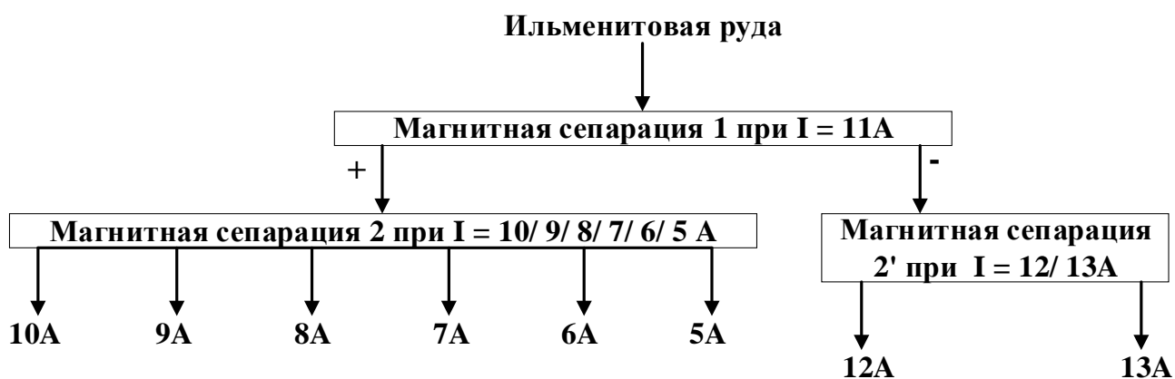
Рисунок 4.5 – Схема 2-х стадийного процесса магнитной сепарации
