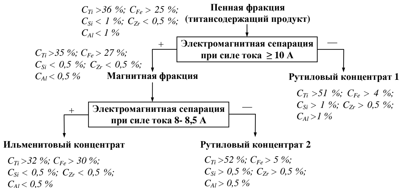
Рисунок 5.3 – Схема электромагнитной сепарации
