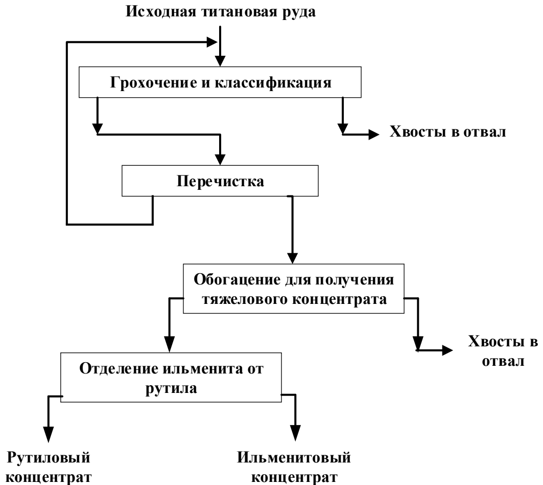
Рисунок 1.6 - Принципиальная схема процесса обогащения титановых руд
