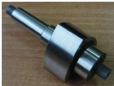
Рисунок 3 – Деталь в форме РК-профиля, полученная методом фрезоточения.
