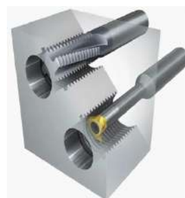
Рис. 3. Нарезание внутренней резьбы фрезой и резьбовым резцом
