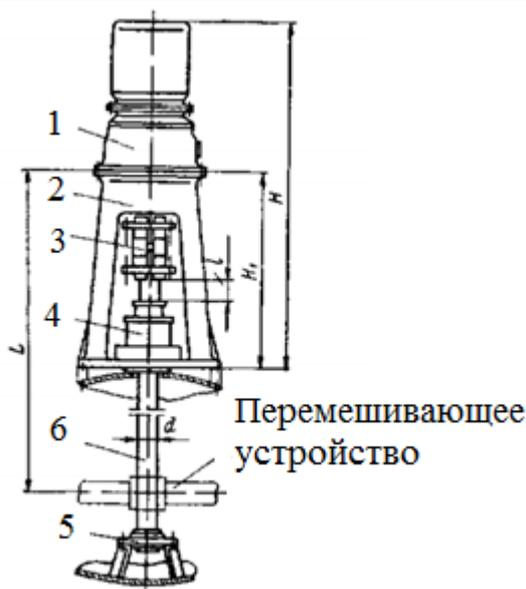
Рисунок 12 – Вертикальный привод с концевой опорой вала:
