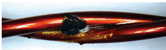
Рис. 8. Характерный вид места пробоя изоляции макетного образца в месте дефекта
