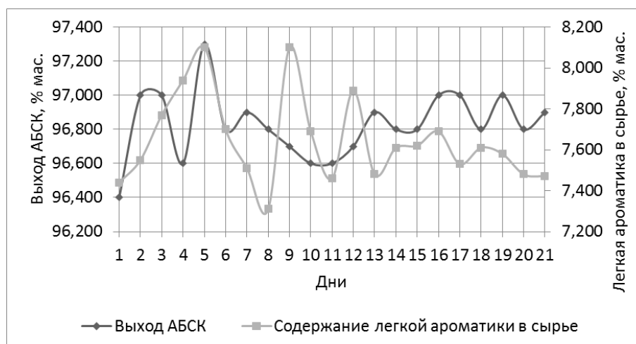
Рисунок 3.3.1.3 – Зависимость выхода алкилбензолсульфокислот от доли легких ароматических углеводородов в сырье за период 27.09.2019 – 17.10.2019
