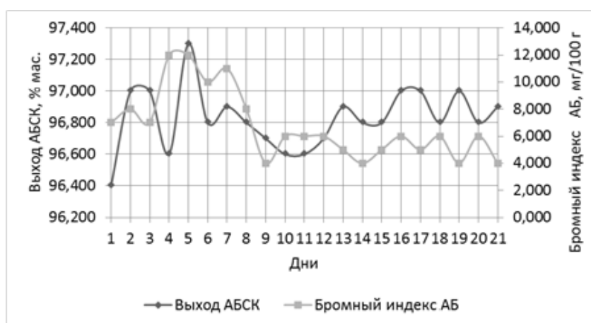
Рисунок 3.3.2.3 – Зависимость выхода алкилбензолсульфокислот от бромного индекса алкилбензолов за период 27.09.2019 – 17.10.2019
