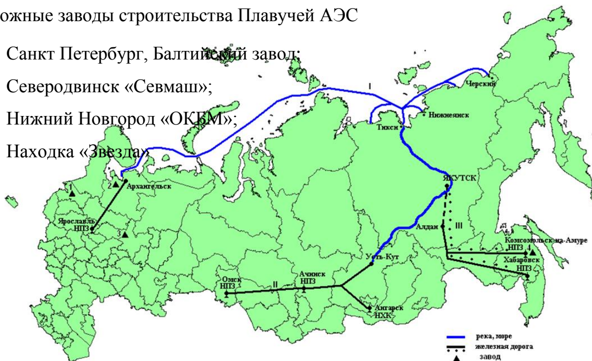
Рисунок 1 — Схема завоза жидкого топлива в Республику Саха (Якутия) и возможные заводы сооружения ПАСММ.
