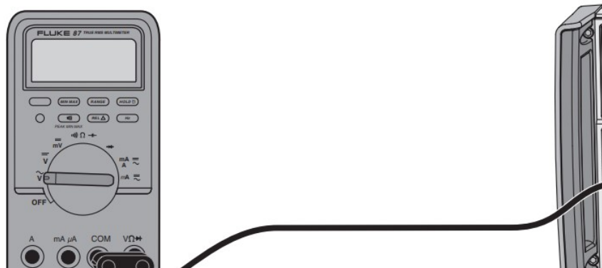
Рисунок 8.1– Подключение мультиметра (Постоянное напряжение/Переменное напряжение)
