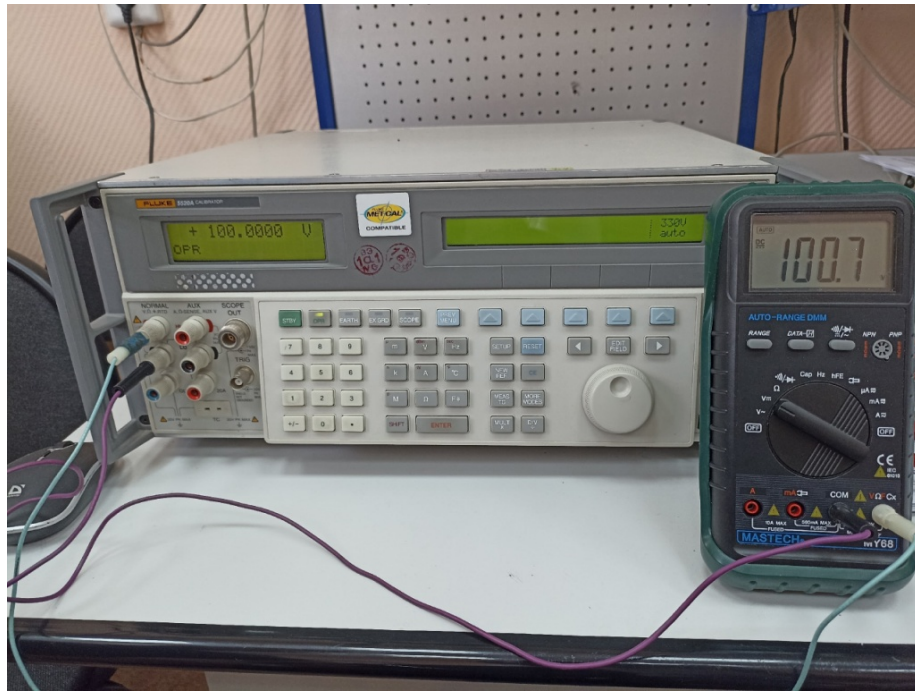
Рисунок 9 – Выходной сигнал постоянного напряжения
