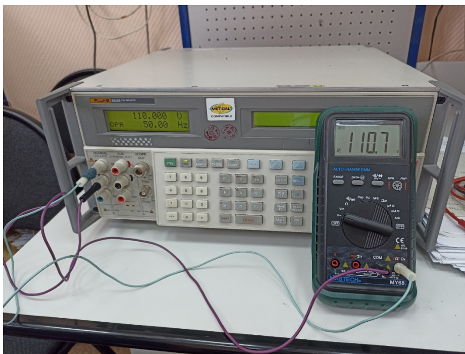
Рисунок 11 – Выходной сигнал переменного напряжения
