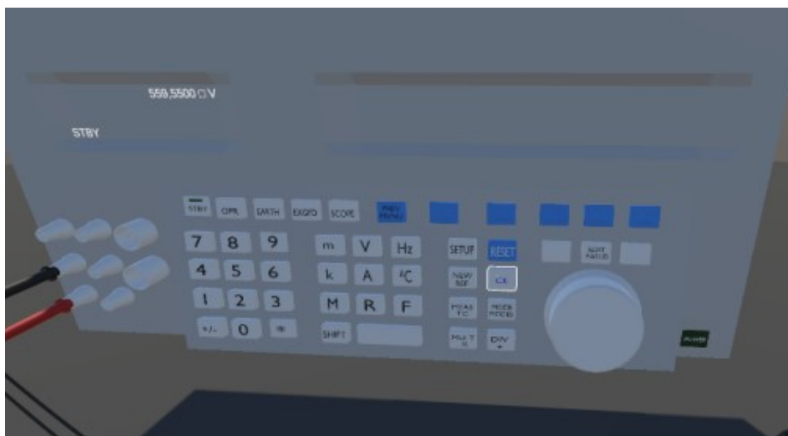
Рисунок 34 – Пример работ калибратора в режиме ожидания и мультиметра
