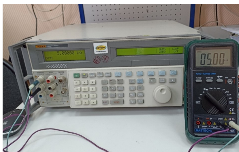
Рисунок 13 – Выходной сигнал сопротивления
