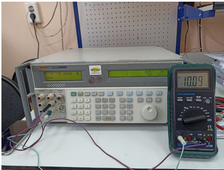
Рисунок 10 – Выходной сигнал постоянного тока
