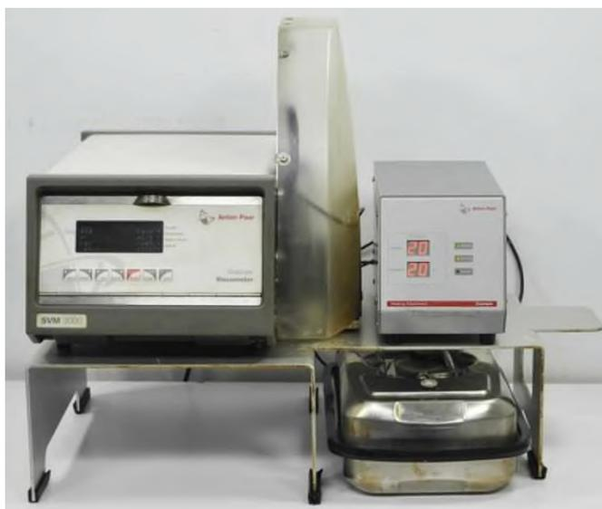
Рисунок 2.4 – Прибор для определения плотности (вискозиметр Штабингера)
