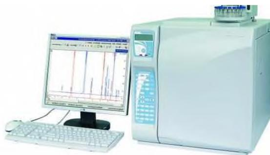
Рисунок 2.7 – Хроматограф лабораторный аналитический газовый
