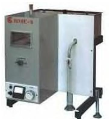
Рисунок 2.5 – Прибор для определения фракционного состава (АРНС-1Э)
