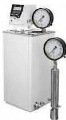
Рисунок 2.6 – Аппарат для определения ДНП по Рейду
