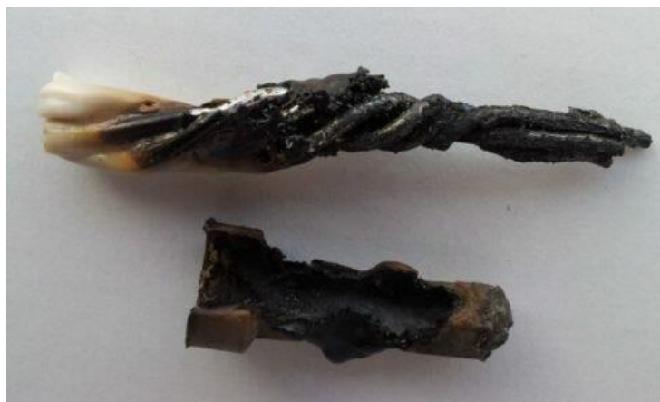
Рисунок 1.2 – Последствия большого переходного сопротивления при соединении проводников методом скрутки
