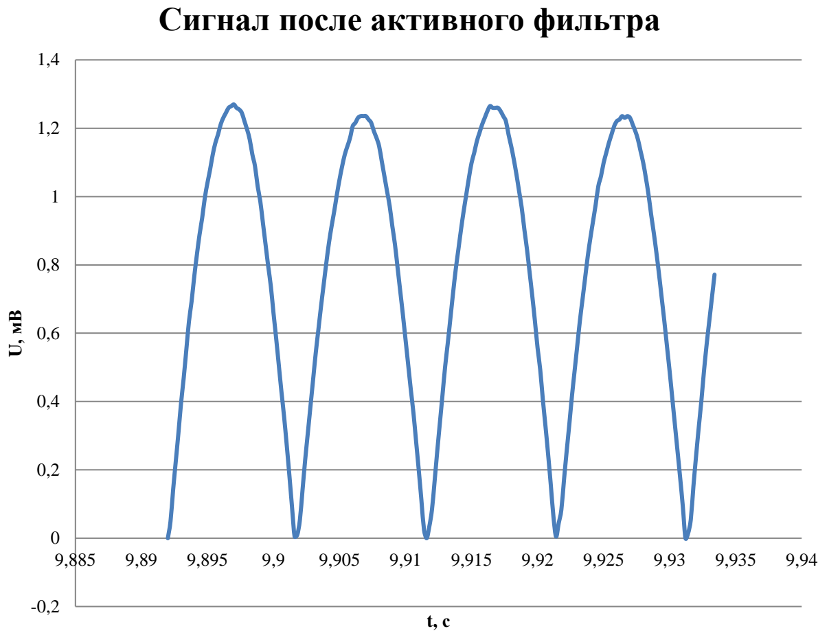
Рисунок 3.5 – Диаграмма напряжений на выходе активного фильтра при отсутствии нагрева термопары
