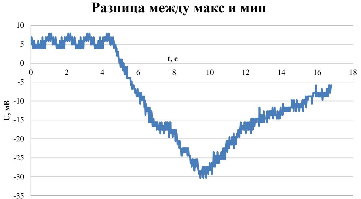
Рисунок 3.4 – Сигнал термоЭДС после обработки
