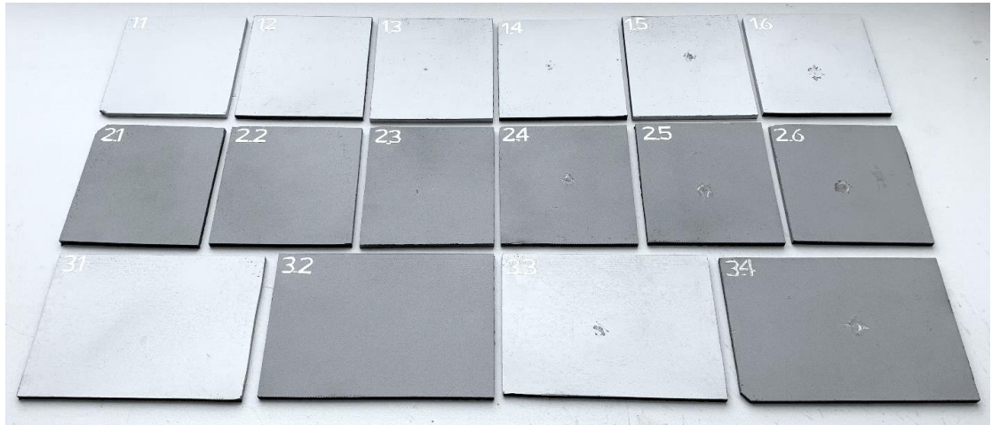
Рисунок 2.1 – Набор стандартных образцов с ударными повреждениями
