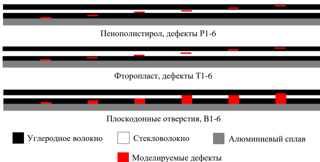
Рисунок 2.10 – Схема расположения слоёв и дефектов в численной модели образца
