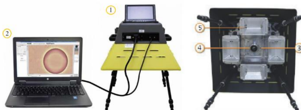
1 – планшетный компьютер, 2 – ноутбук, 3 – оптическая камера, 4 – тепловизионный модуль, 5 – источники нагрева (галогеновые лампы)
