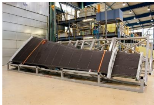
в) кессон крыла МС-21, изготовленный из российских композитов
