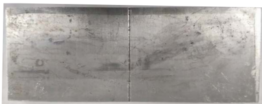
Рисунок 3 – Тестовый образец с прямоугольным пазом
