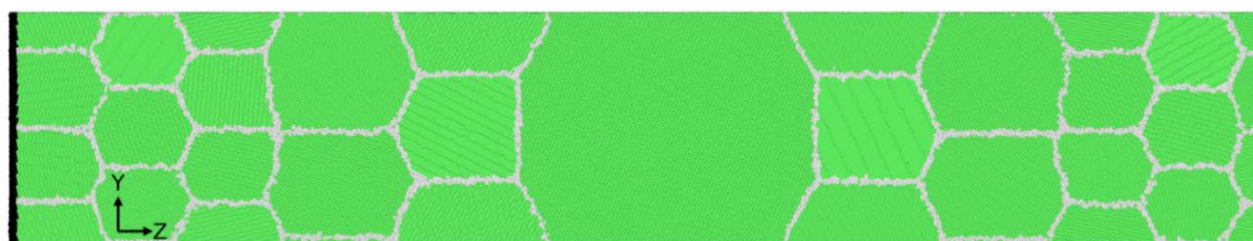
Рисунок 1 - Сечение образца с градиентной зеренной структурой в плоскости YZ. Черным цветом выделен ударник, зеленым и серым цветом отмечены атомы зерен и межзеренных границ, соответственно
