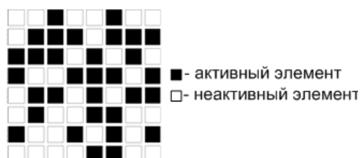
Рисунок 3 – Рассмотренная конфигурация разреженной матричной антенной решетки
