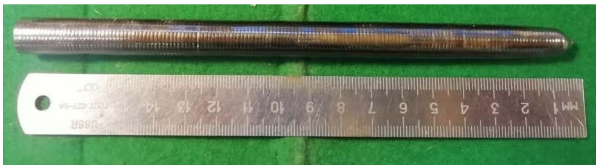
Рисунок 1 - Монокристаллический стержень вольфрама, полученный методом электро-лучевого переплава
