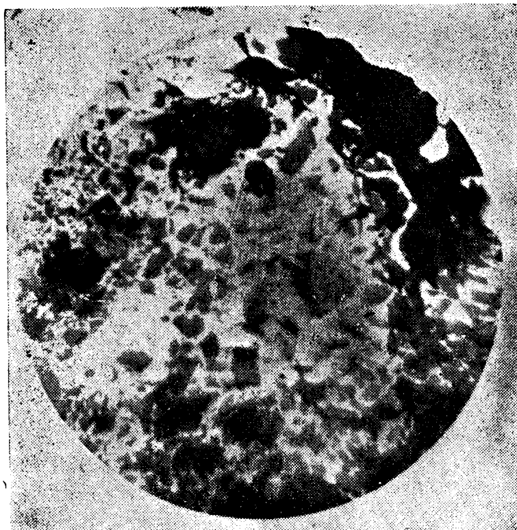
Фиг. 9. Раскрошенная структура замещения сфалерита (серое) галенитом (белое); черное — жильный минерал. Свэг отраженный.
