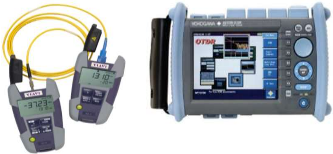
Рисунок 28 - Приборы, использованные для измерения дополнительных потерь
