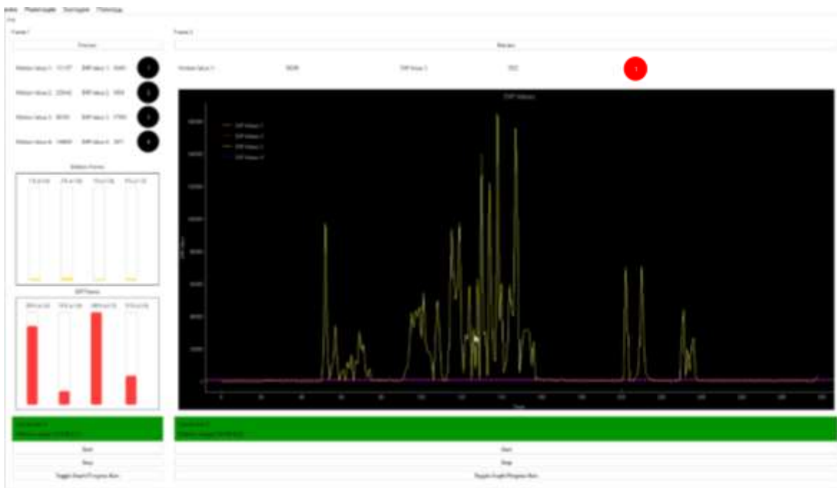
Рисунок 2К - Снимок с экрана компьютера при нескольких воздействиях на ВОК и срабатывание сигнализации
