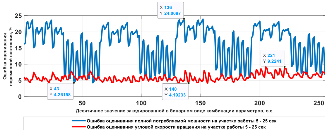
Рисунок 4.2.5. Результаты полного факторного эксперимента при исследовании ошибки оценивания угловой скорости вращения АД (красная) и МППМ (синяя) при вариации параметров на участке работы 5–25 сек
