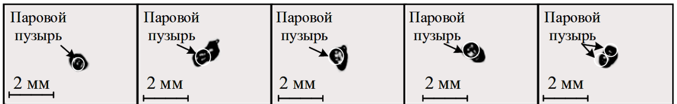
Рисунок 2.4.2 – Типичные видеокadres двухфазных капель (вода–пар) после выхода из разогретых форсунок при температуре газовой среды T_g=100\text{--}400\text{ }^\circ\text{C}
