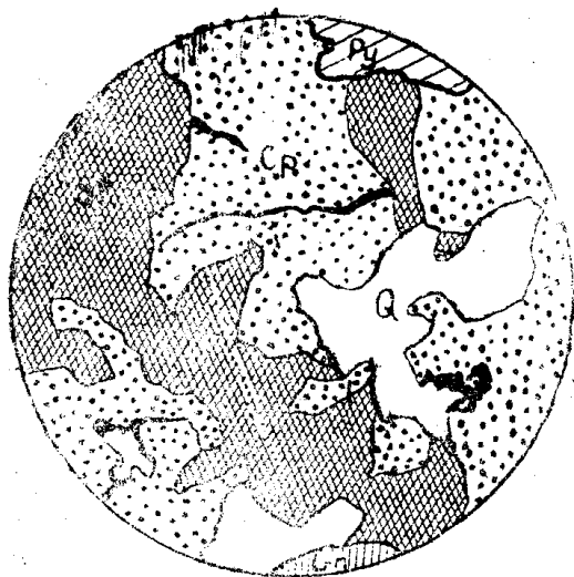
Рис. 10. Нитеобразная структура замещения халькопирита (Cr) ковелином (черный). Sl—сфалерит; Py—пирит; Q—жильный минерал. Ув. 375.
