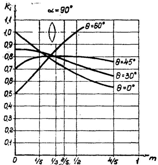
Фиг. 8. Коэффициент  $K_1$  на контуре эллиптических шайб с различной степенью сжатия эллипса ( $m$ )
