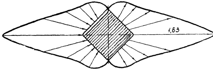
Фиг. 16. Концентрация напряжений  $K_3$  в формуле  $M_D = K_3 \frac{M}{2\pi}$  на контуре квадратной шайбы ( $m = \frac{1}{9}$ ) при изгибе ( $\alpha = 0^\circ$ )
