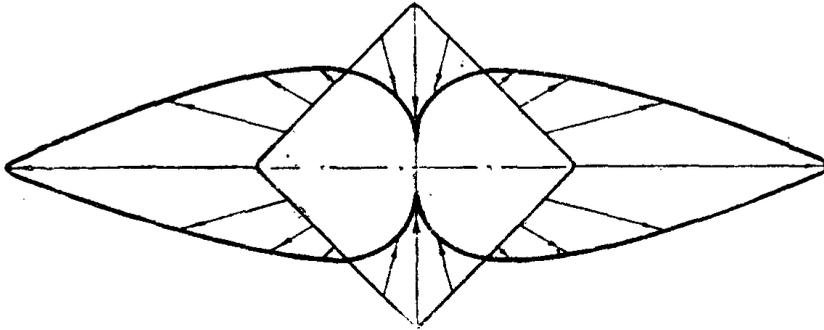
Фиг. 5. Распределение изгибающих моментов по контуру квадратной шайбы при  $\alpha = 0^\circ$  ( $\nu = 0,3$ )
