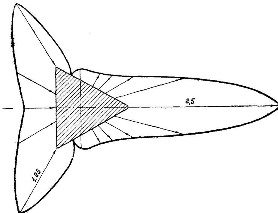
Фиг. 15. Концентрация напряжений  $K_2$  в формуле  $M_p = K_2 \frac{M}{2\pi}$  на контуре треугольной шайбы ( $m = \frac{1}{4}$ ) при несимметричном изгибе моментом
