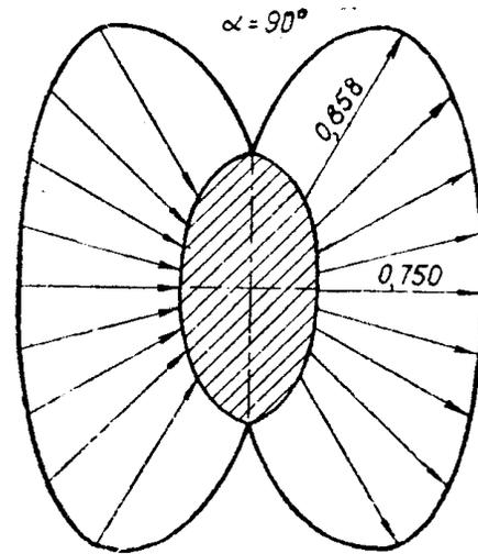
Фиг. 13. Концентрация напряжений  $K_1$  на контуре эллиптической шайбы ( $m = \frac{1}{8}$ ) при несимметричном изгибе
