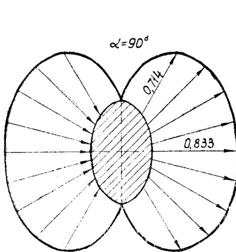
Фиг. 12. Концентрация напряжений  $K_1$  на контуре эллиптической шайбы при несимметричном изгибе ( $m = \frac{1}{5}$ )
