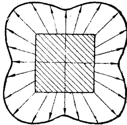
Фиг. 6. Распределение изгибающих моментов по контуру квадратной шайбы при  $\alpha = 45^\circ$  ( $\nu = 0,3$ )
