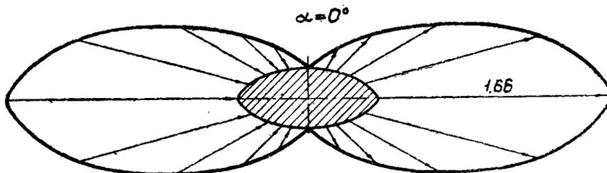
Фиг. 11. Концентрация напряжений  $K_1$  в формуле  $M_p = K_1 \frac{M}{2\pi}$  на контуре эллиптической шайбы ( $m = \frac{2}{5}$ ) при изгибе
