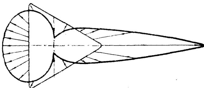
Фиг. 4. Распределение изгибающих моментов по контуру треугольной шайбы при  $\alpha = 0^\circ$  ( $\mu = 0,3$ ),  $m = \frac{1}{4}$
