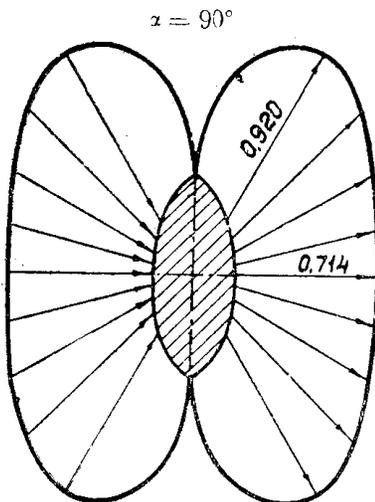
Фиг. 14. Концентрация напряжений  $K_1$  на контуре эллиптической шайбы ( $m = \frac{2}{5}$ ) при несимметричном изгибе
