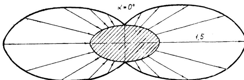
Фиг. 10. Концентрация напряжений  $K_{1n}$  в формуле  $M_p = K_{1n} \frac{M}{2\pi}$  на контуре эллиптической шайбы  $m = \frac{1}{3}$  при несимметричном изгибе моментом
