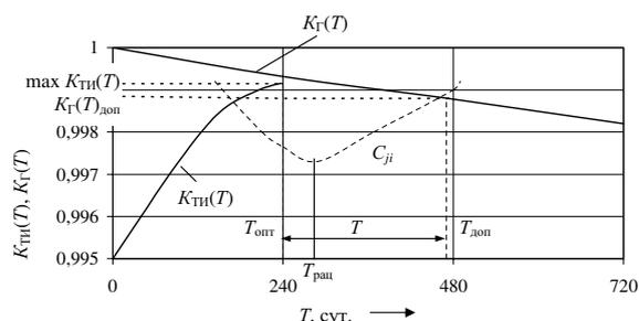
Рис. 2. Зависимости  $K_{ГП(Т)}$ ,  $K_{Г(Т)}$ ;  $T_{онт} \leq T \leq T_{доп}$ ,  $T_{рац} := T$ , при  $C_{ji} = \min C_{ji}$
