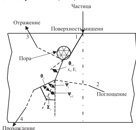
Рис. 3. Схема траектории: x_i, E_i – свободный пробег и энергия частицы на i -ом отрезке траектории; \theta_i, \psi_i, \chi_i – углы, определяющие сферический угол рассеяния; 1) вход частицы; ветви траекторий на: 2) поглощение; 3) обратное рассеяние; 4) прохождение экрана
