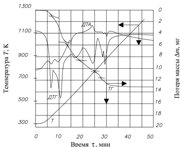
**Рисунок.** Дериwатoгpамма ураната аммония  $(\text{NH}_4)_2\text{U}_4\text{O}_{13} \cdot 5\text{H}_2\text{O}$  в атмосфере воздуха
