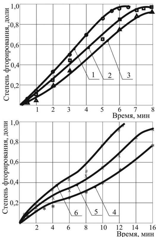
**Рис. 2.** Зависимость степени фторирования порошка твердого сплава на основе карбида вольфрама ВК-6 элементарным фтором от времени при температуре: 1) 300; 2) 350; 3) 370; 4) 400; 5) 420; 6) 450 °С
