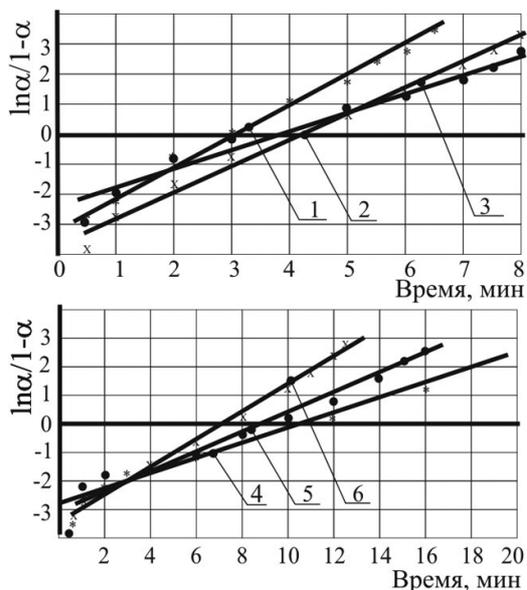
**Рис. 3.** Математическая обработка кинетических данных фторирования порошка твердого сплава на основе карбида вольфрама ВК-6 элементарным фтором по уравнению Проута-Томпкинса при температуре: 1) 300; 2) 350; 3) 370; 4) 400; 5) 420; 6) 450 °С
