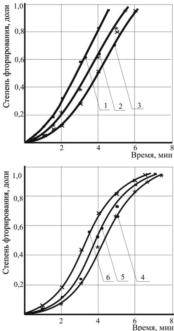
Рис. 4. Зависимость степени фторирования порошка кобальта от времени и температуры: 1) 250; 2) 300; 3) 350; 4) 370; 5) 400; 6) 450 °С
