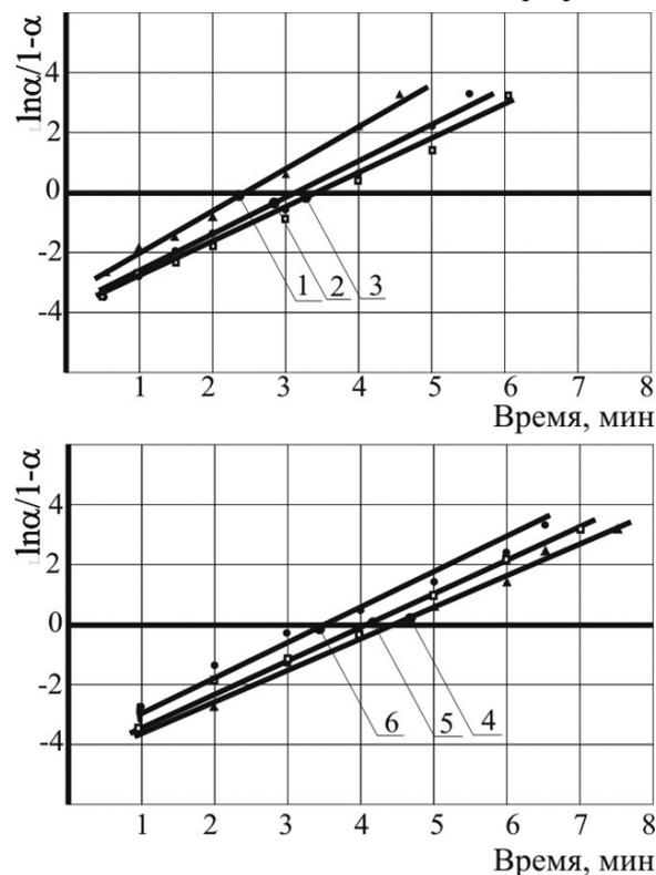
Рис. 5. Математическая обработка кинетических данных фторирования порошка кобальта элементарным фтором по уравнению Проута-Томпкинса при температуре: 1) 250; 2) 300; 3) 350; 4) 370; 5) 400; 6) 450 °С
