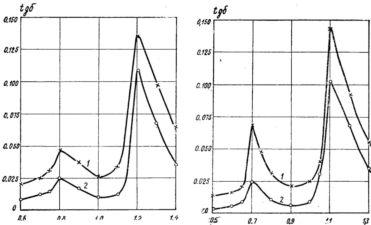
Рис. 1. Зависимость диэлектрических потерь калиевых алюмосиликатных стекол от содержания окиси алюминия.
