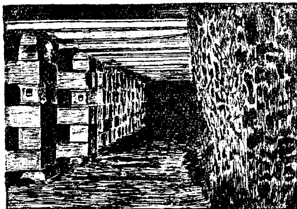
Рис. 5. Разборные переносные костры с консолями в очистном забое
