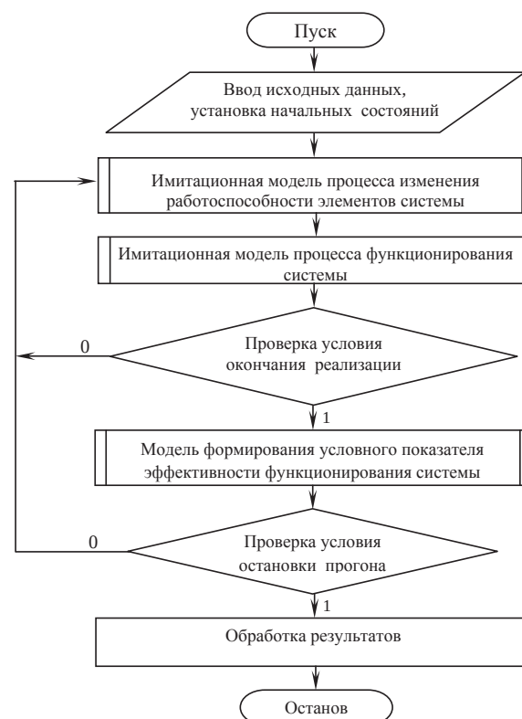
Рис. 1. Общий вид компьютерной модели, ориентированной на исследование эффективности функционирования СТС
