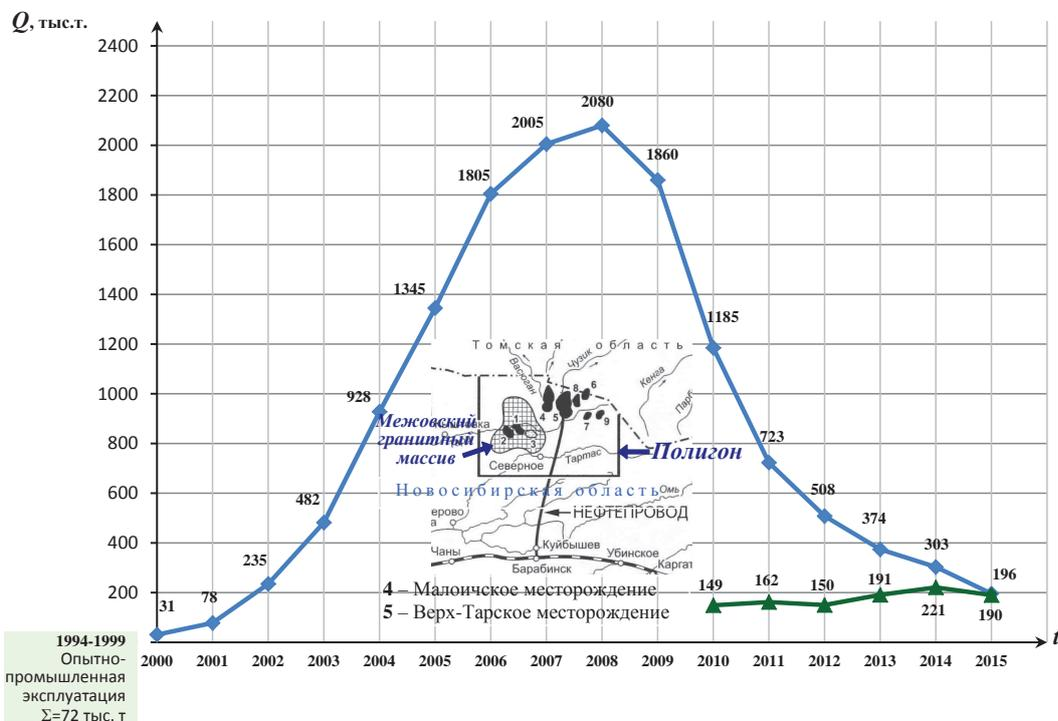
Рис. 5. Динамика добычи нефти на Верх-Тарском месторождении по годам. Суммарная добыча на 01.01.2015 г. составила **14 млн 46 тыс. т.** Геологические запасы – **52 млн т.** Зеленым показана начавшаяся позднее добыча нефти на Малоичском месторождении из палеозоя. В 2015 г. добыча снизилась по сравнению с 2014 г. на 26 %
