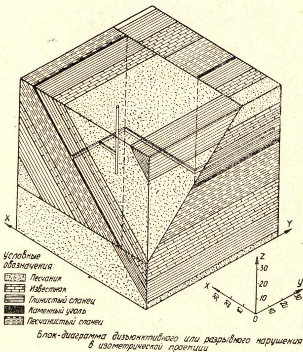
Блок-диаграмма дизъюнктивного или разрывного нарушения в изометрической проекции
