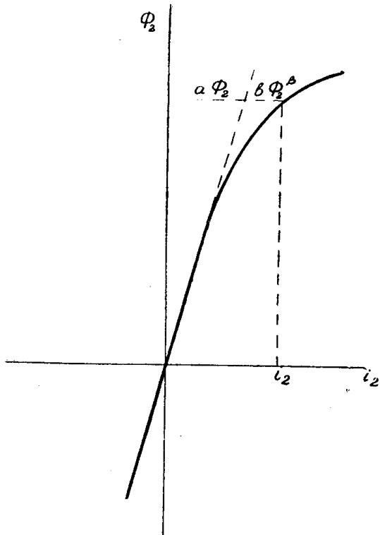
Рис. 2. Кривая намагничивания по поперечной оси усилителя.
