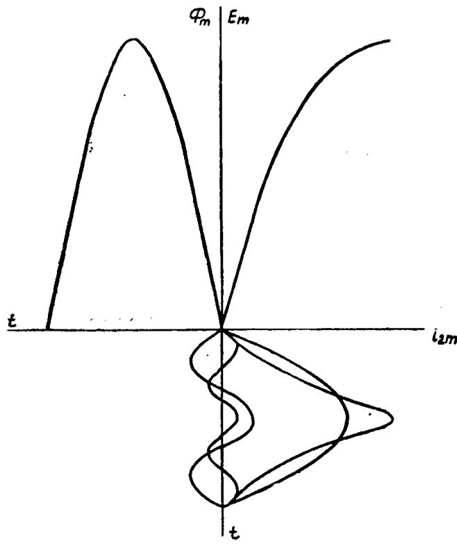
Рис. 1. Графический способ разложения кривой тока поперечной цепи.
