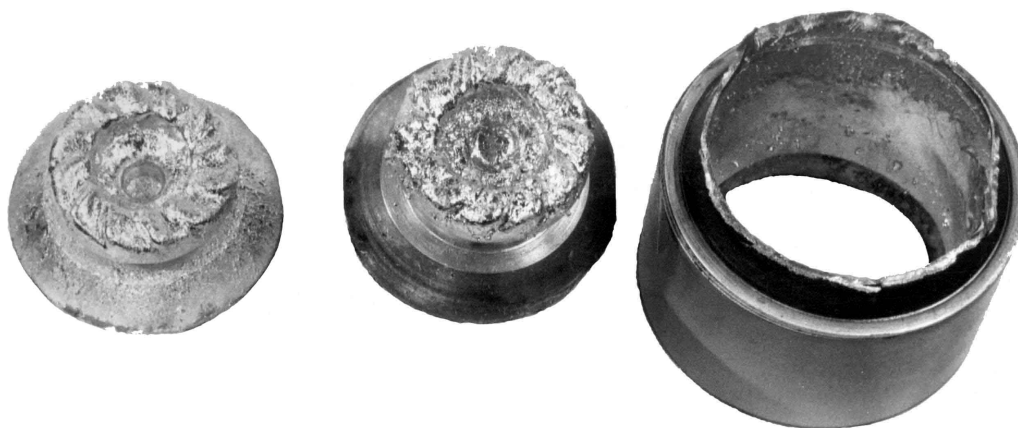
Рис. 4. Состояние элементов разрядника с электродами по рис. 1, в
