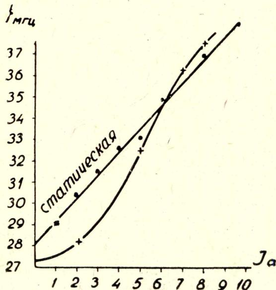
Рис. 1. Динамическая и статическая модуляционная характеристика автогенератора
