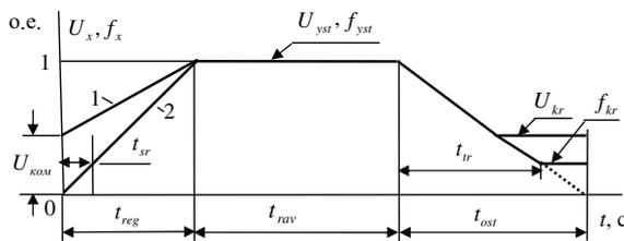
Рис. 2. Диаграммы напряжения и частоты ПЧ: 1) напряжение  $U_x$ , 2) частота  $f_x$
