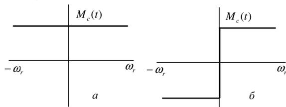
Рис. 1. Механическая характеристика нагрузочного момента
