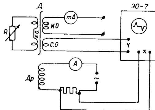
Рис. 2. Схема для измерения и автоматической коррекции ширины петли гистерезиса пермаллоевого сердечника методом импульсов
