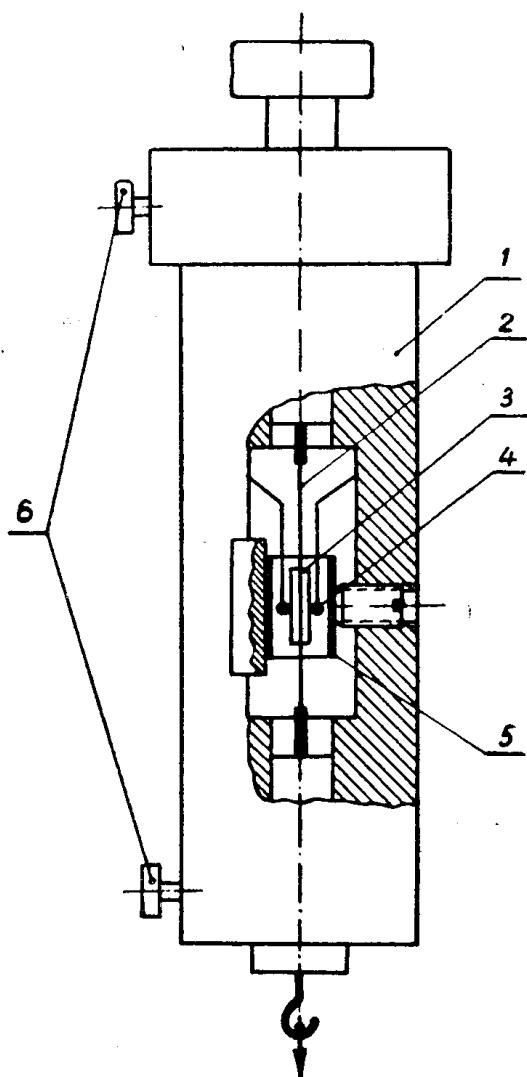
Рис. 1. Устройство для вытяжки пермаллоевого сердечника в магнитном поле: 1—обойма, 2 — пермаллоевый сердечник, 3 — кварцевая трубочка, 4 — сигнальная обмотка, 5 — стеклянная трубка, 6 — зажимные винты
