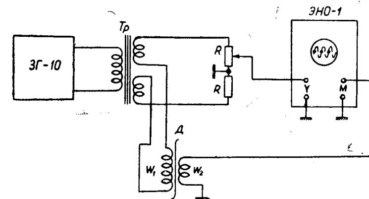
Рис. 3. Схема для измерения ширины петли гистерезиса пермаллоевого сердечника методом модуляции поля возбуждения
