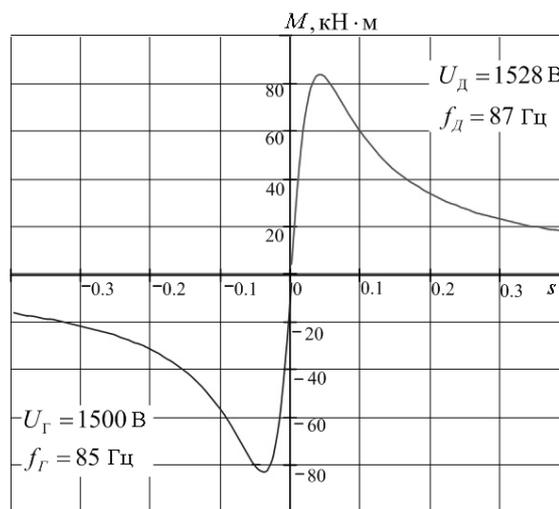
Рис. 3. Механическая характеристика асинхронный двигатель – асинхронный генератор
