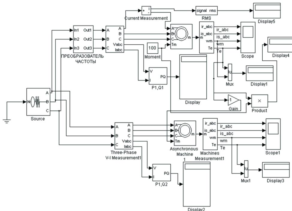
Рис. 4. Модель схемы взаимной нагрузки асинхронный двигатель – асинхронный генератор
