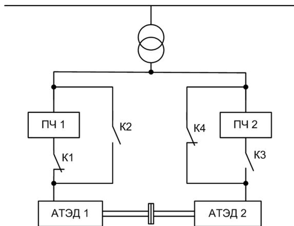
Рис. 1. Схема испытания АТЭД
