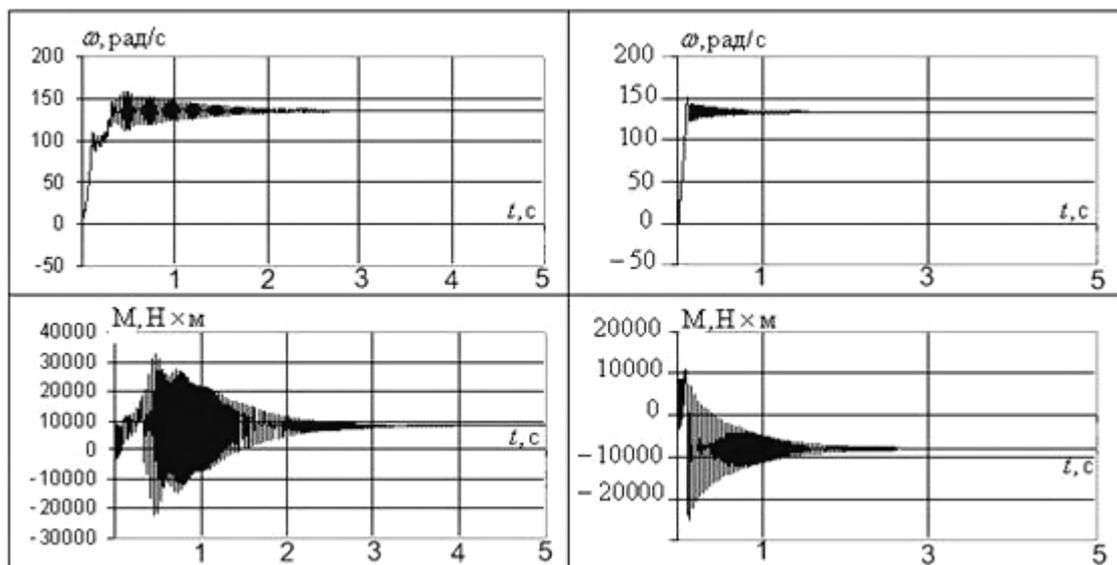
Рис. 5. Зависимости скоростей и моментов асинхронных тяговых машин (слева характеристики двигателя, справа генератора)
