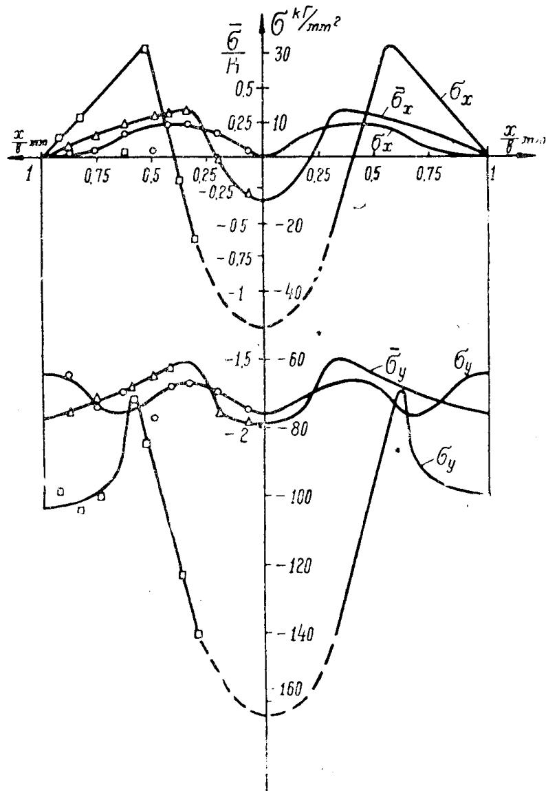
Рис. 2. Эпюры главных напряжений вдоль горизонтальной оси симметрии:  $\circ$  — осадка 10%,  $\square$  — осадка 30%,  $\triangle$  — для идеально-пластического материала.
