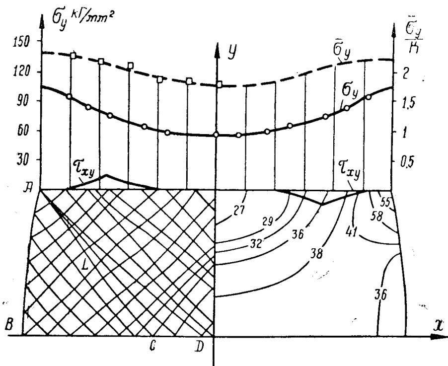
Рис. 1. Эпюры контактных напряжений, сетка линий скольжения и изосклеры при осадке 10%: ○ — для стали X18H9T, □ — для идеально-пластического материала.
