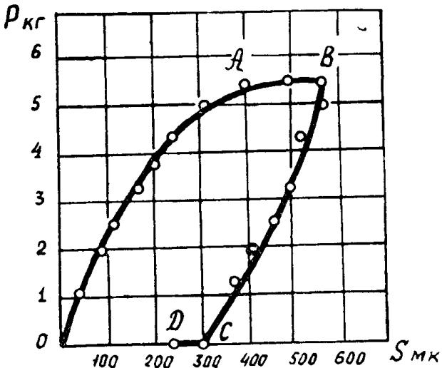
Рис. 1. Смещение стали по конвейерной резине.
