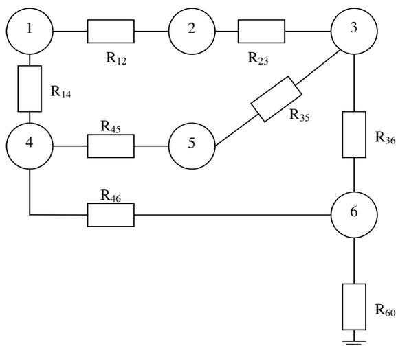
**Рис. 1.** Упрощенная тепловая схема закрытого асинхронного двигателя с короткозамкнутым ротором: 1) лобовая часть обмотки статора; 2) пазовая часть обмотки статора; 3) сердечник статора; 4) внутренний воздух; 5) ротор; 6) корпус двигателя
