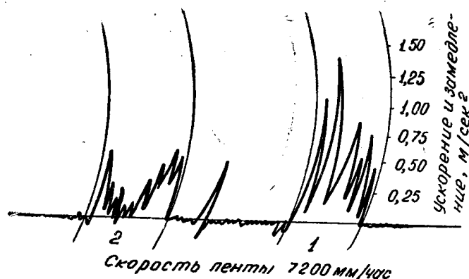
Рис. 2. Диаграммы ускорений (1) и замедлений (2) скиповой подъемной установки шахты «Капитальная-1» треста «Осинникиуголь»
