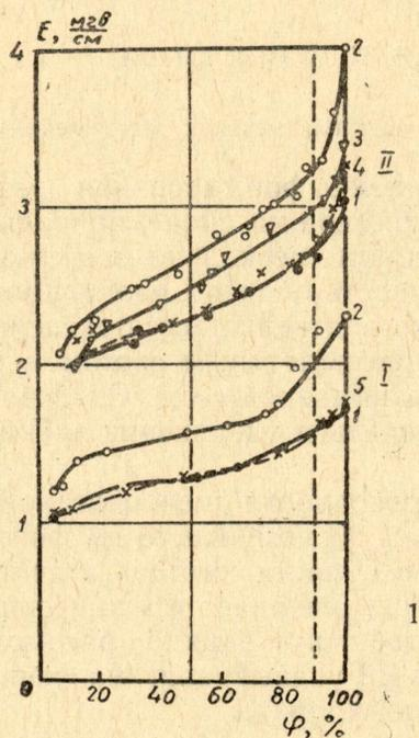
Рис. 1. Зависимость пробивной напряженности каменной соли от вероятности пробоя с графитовыми электродами: I — толщина  $d = 60$  мк; II — толщина  $d = 10$  мк, 1 — без предварительного воздействия напряжением, 2 — с предварительным воздействием напряжением, 3 — с предварительным воздействием импульсов и слабым освещением ультрафиолетовым светом, 4 — с предварительным воздействием импульсов и сильным освещением, 5 — влияние изменения полярности импульса.
