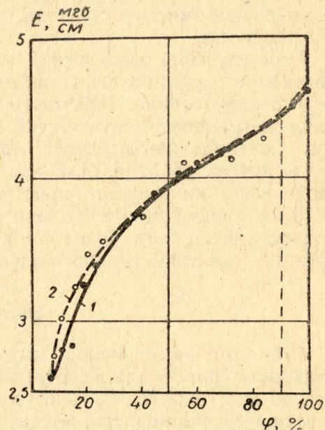
Рис. 3. Зависимость пробивной напряженности каменной соли толщиной 10 мк от вероятности пробоя с жидкостными электродами: 1 — без предварительного воздействия напряжением, 2 — с предварительным воздействием напряжением.
