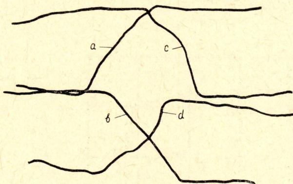
Рис. 4 Кривые тока продольной а и б и поперечно с и d цепей под щетками обеих полярностей.
