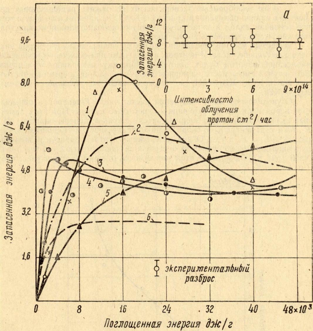
Рис. 7. Влияние предыстории и интенсивности протонного облучения на кинетику накопления запасенной энергии в  $\text{NaCl}$ .
