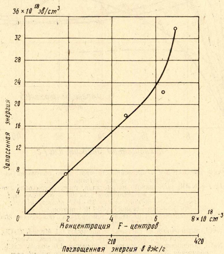
Рис. 8. Зависимость запасенной энергии от концентрации
