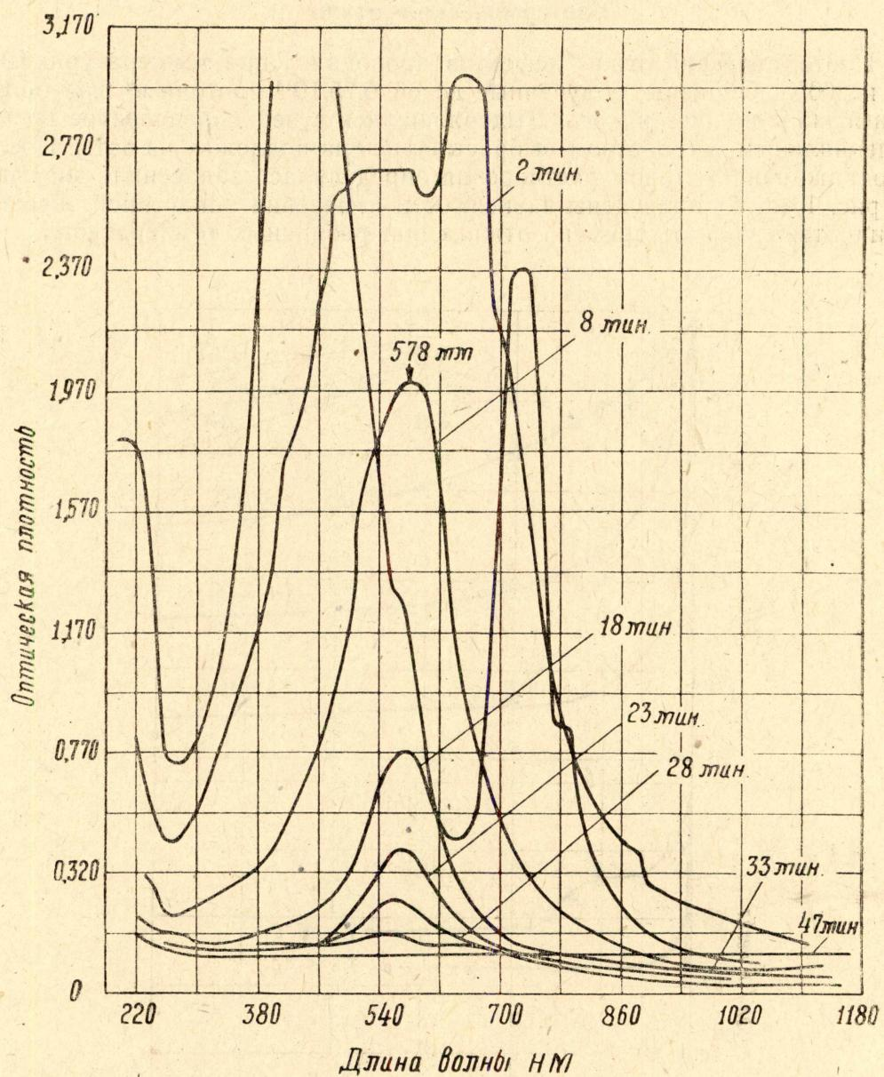
Рис. 2. Изотермический отжиг при  $200^{\circ}\text{C}$  центров окраски в NaCl, облученном протонами дозой  $6,75 \cdot 10^{14}$  протон/ $\text{см}^2$
