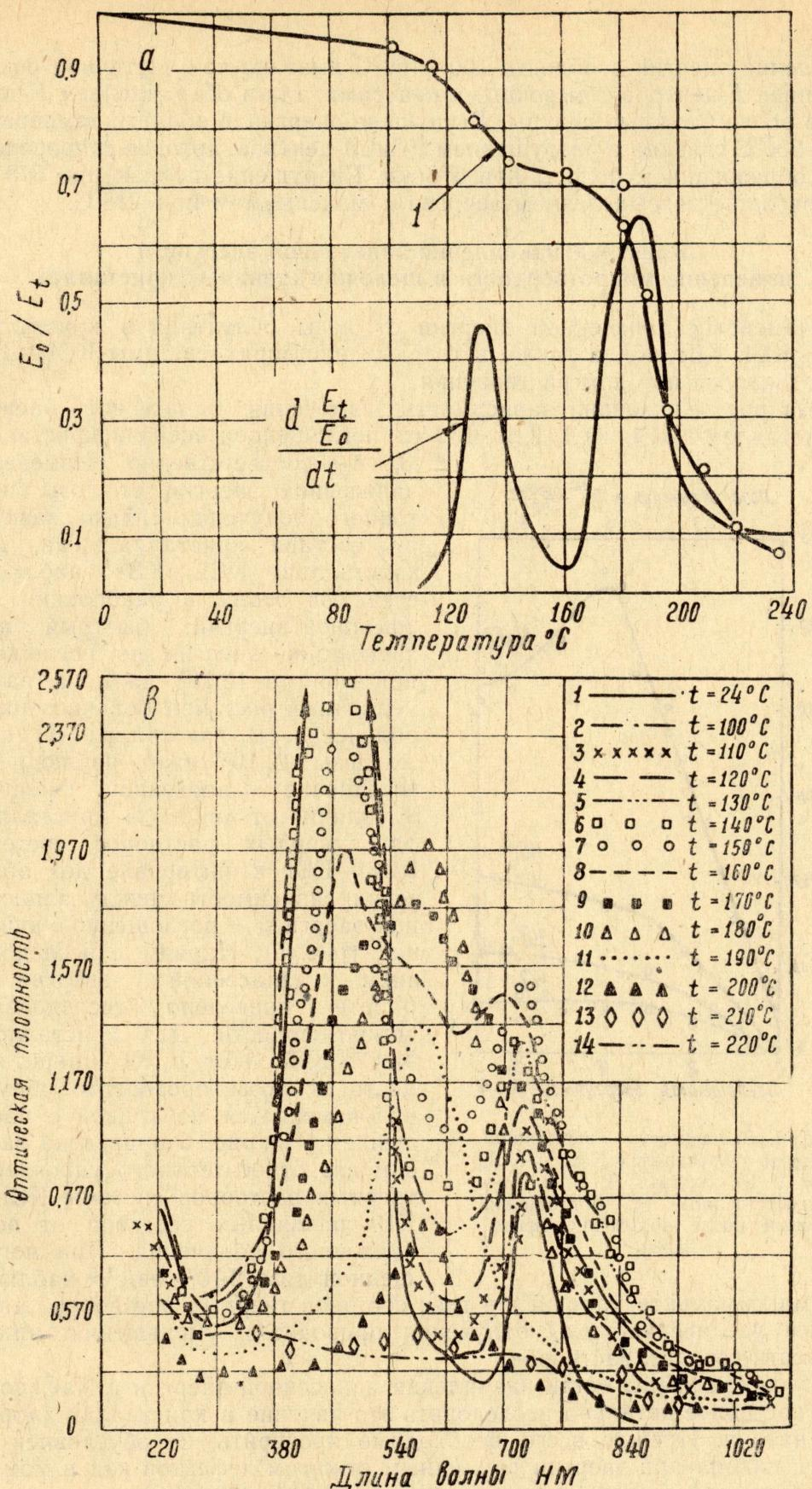
Рис. 3. Зависимость  $E_t$  от температуры отжига в кристаллах NaCl, облученных протонами дозой  $6,75 \cdot 10^{14}$  протон/ $\text{см}^2$  (3, а, кривая 1) и изменение оптического поглощения NaCl, облученных протонами при различных температурах отжига (3, б)
