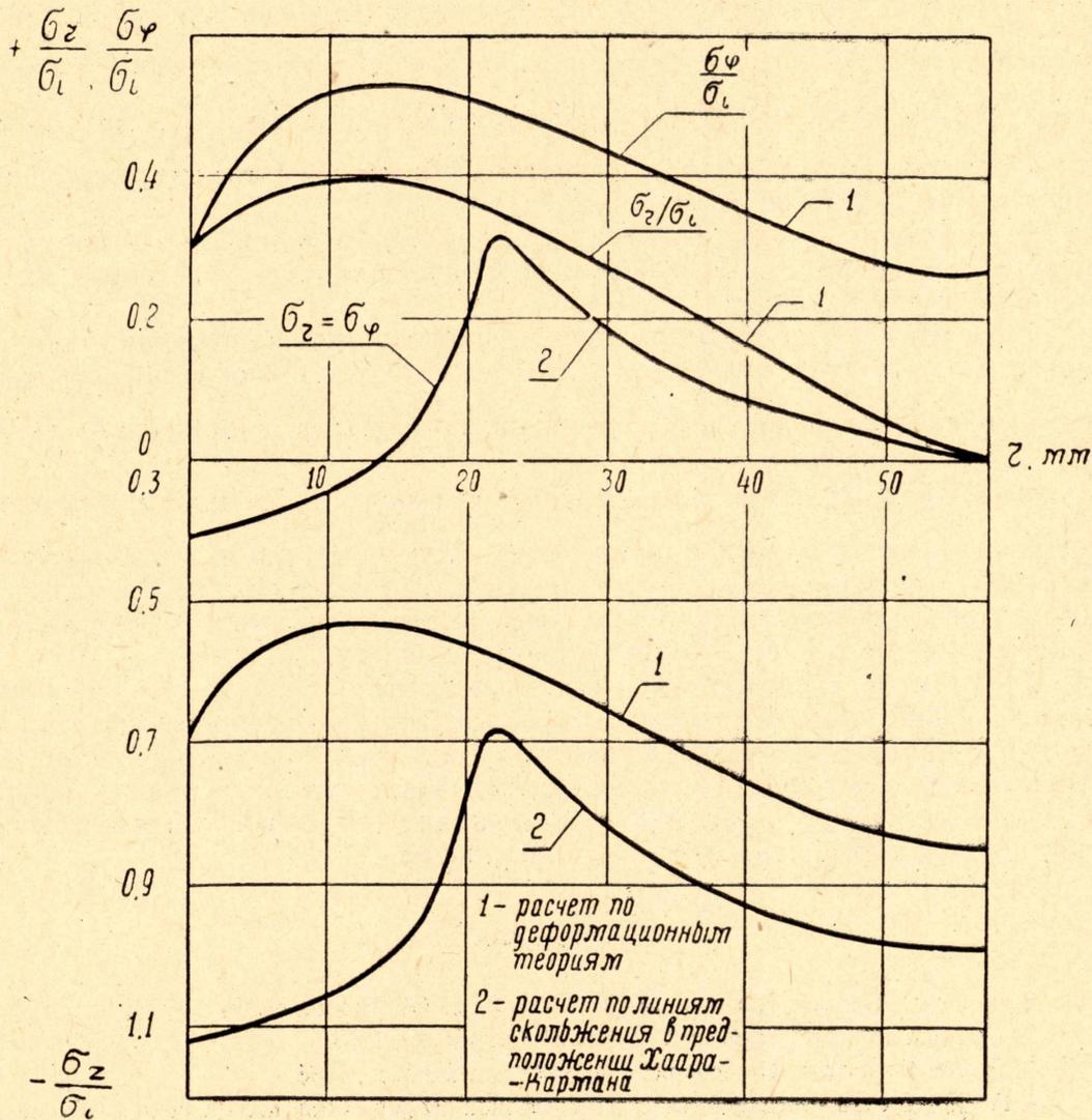
Рис. 3. Напряжения при осадке цилиндра.
