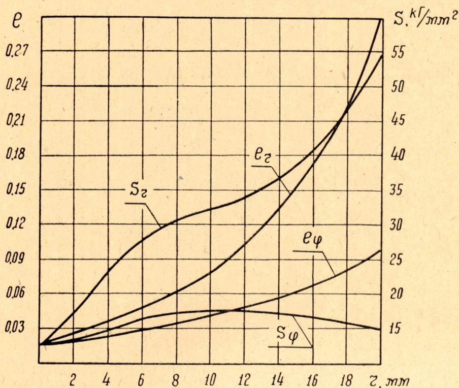
Рис. 2. Компоненты девиатора напряжений и деформации на торце осаживаемого цилиндра
