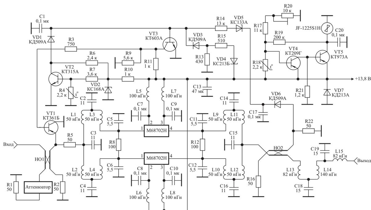
Рис. 3. Полосовой усилитель мощности с системой защиты
