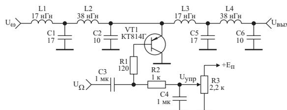
Рис. 7. Устройство регулировки и модуляции амплитуды мощных сигналов
