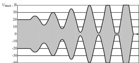
Рис. 8. Зависимость формы огибающей сигнала на выходе устройства при плавном увеличении напряжения модулирующего моногармонического сигнала
