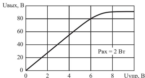
Рис. 4. Зависимость выходного напряжения усилителя от напряжения управления
