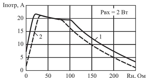
Рис. 6. Зависимости тока, потребляемого усилителем, от сопротивления нагрузки
