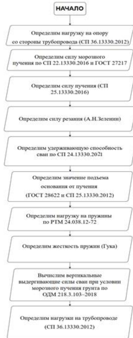
Рис. 3. Последовательность расчета опор трубопроводов при условии морозного пучения грунта. Для определения силы резания грунта воспользуемся формулой доктора технических наук профессора А.Н. Зеленина, который разработал теорию резания грунтов на основе результатов экспериментальных исследований, для определения жесткости пружин воспользуемся законом Гука
